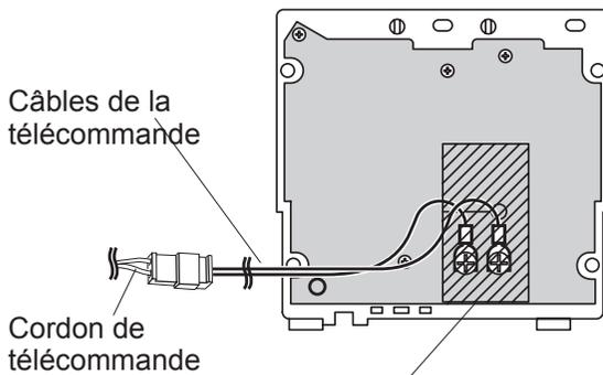
\* Vérifiez que la borne est couverte par la section A (▨) du couvercle isolant (claire, voir Fig. 1).
