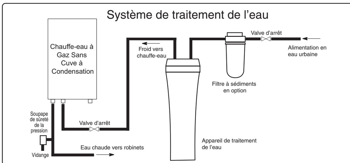
▲ L'illustration est donnée à titre d'exemple. Vérifiez sur le chauffe-eau réel la position de la tuyauterie et sa forme.
