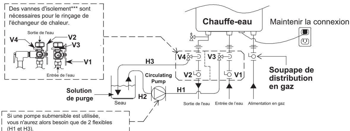
\*\*\* Les clapets d'isolement peuvent être achetés comme accessoire auprès d'un revendeur Noritz agréé. Ils permettent un test de diagnostic complet et une purge facile du système. Prenez contact avec Noritz America pour de plus amples informations. (866-766-7489)
