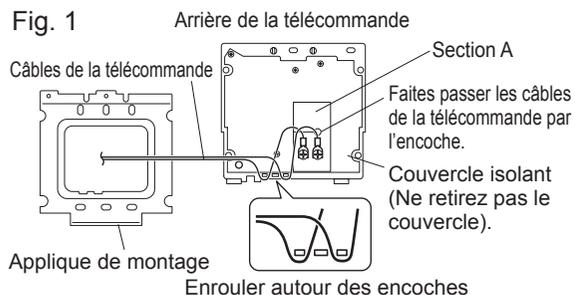
5. Fixez la télécommande à l'applique de montage. Insérez le bas de la télécommande dans la rainure au bas de l'applique et enfoncez complètement les 2 crochets sur le haut de la télécommande.
